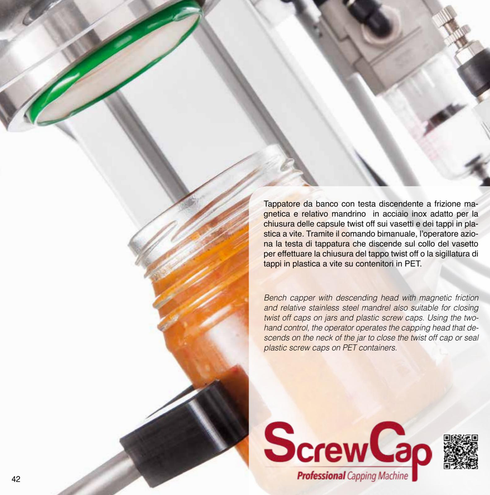
Tappatore da banco con testa discendente a frizione magnetica e relativo mandrino in acciaio inox adatto per la chiusura delle capsule twist off sui vasetti e dei tappi in plastica a vite. Tramite il comando bimanuale, l'operatore aziona la testa di tappatura che discende sul collo del vasetto per effettuare la chiusura del tappo twist off o la sigillatura di tappi in plastica a vite su contenitori in PET.
