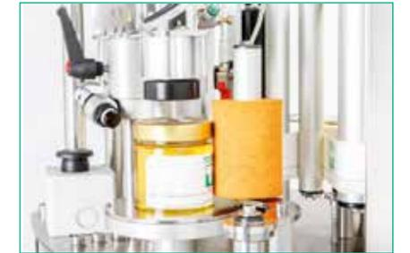
*Étiqueteuse de table à plateau tournant équipée d'une station d'application d'étiquettes autocollantes sur récipients cylindriques, carrés, coniques ou profilés. En installant certains accessoires, la machine est capable d'appliquer la contre-étiquette, de rechercher des étiquettes sur des contenants déjà étiquetés, d'imprimer le lot de production et/ou la date d'expiration.*
