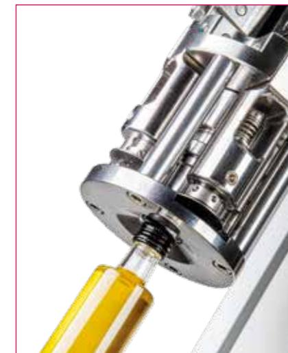
Tappatore da banco con testa discendente in acciaio inox a 4 rulli adatto per la sigillatura di capsule a vite in alluminio liscio di tipo pilferproof con o senza versatore. Cambiando la testa di tappatura, è possibile effettuare la chiusura di ogni tipo di capsula in alluminio a vite, incluse le bottiglie mignon, le capsule in alluminio tipo Stelvin e le capsule tipo MCA.
