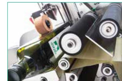
Macchina etichettatrice semi automatica attrezzata con una sola stazione di etichettatura, adatta per l'applicazione di un'etichetta (oppure etichetta e retro con rotolo misto) su formati cilindrici. Mediante installazione di alcuni accessori, la macchina è in grado di etichettare anche piccoli formati cilindrici, flaconi quadrati o rettangolari, applicare etichette avvolgenti o semi-avvolgenti, stampare il lotto di produzione e/o la data di scadenza.
