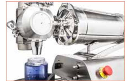
*Doseuses volumétriques à fonctionnement pneumatique, pour le conditionnement de crèmes, pâtes, peintures, cires, résines et autres produits chimiques de différentes viscosités, même à chaud.*
