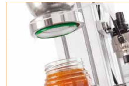
*Boucheuse de table avec tête descendante à friction magnétique et mandrin en acier inoxydable également adaptée pour fermer les bouchons à visser sur les baux et les bouchons à vis en plastique. À l'aide de la commande bimanuelle, l'opérateur actionne la tête de bouchage qui descend sur le col du pot pour fermer le bouchon à visser ou sceller les bouchons à vis en plastique sur les récipients en PET.*
