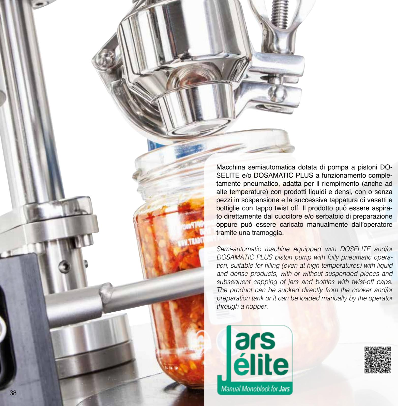
Macchina semiautomatica dotata di pompa a pistoni DOSELITE e/o DOSAMATIC PLUS a funzionamento completamente pneumatico, adatta per il riempimento (anche ad alte temperature) con prodotti liquidi e densi, con o senza pezzi in sospensione e la successiva tappatura di vasetti e bottiglie con tappo twist off. Il prodotto può essere aspirato direttamente dal cuocitore e/o serbatoio di preparazione oppure può essere caricato manualmente dall'operatore tramite una tramoggia.
