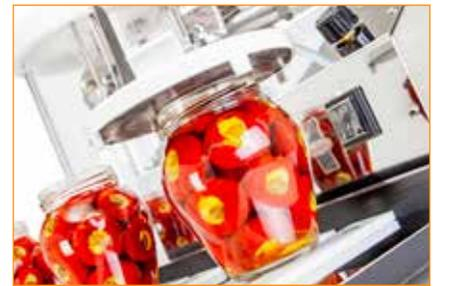
*Remplisseur de jutage sous vide de table pour le remplissage d'huile, de vinaigre, de saumure, de sirops, d'alcool et de liquide de conservation dans des bocaux en verre. La remplisseuse ENOLMASTER peut être équipée d'une pompe à vide électrique ou pneumatique. La tête de remplissage est équipée d'un bouton poussoir en acier inoxydable AISI 316. Le bocal de récupération de liquide est disponible en plastique ou en verre pyrex.*
